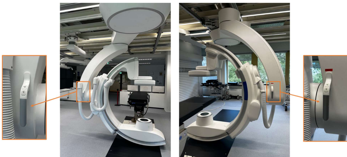
Figura 3: Mâner cu comenzi de frânare pe ambele laturi ale stativului FlexArm
