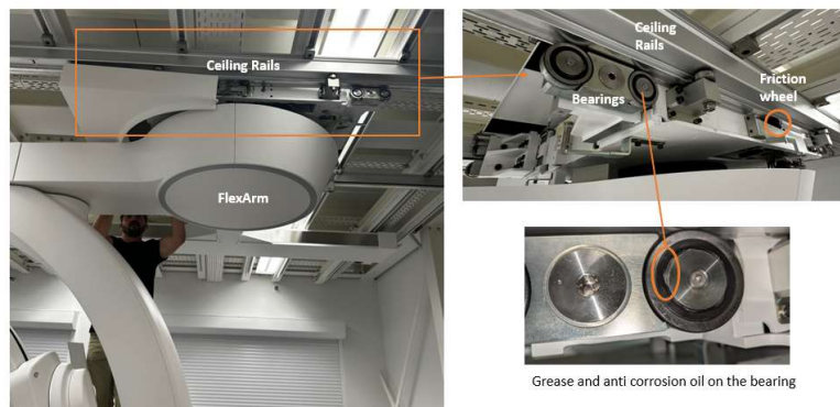
Figura 2. Prezentare generală a elementelor stativului FlexArm și identificarea problemei
